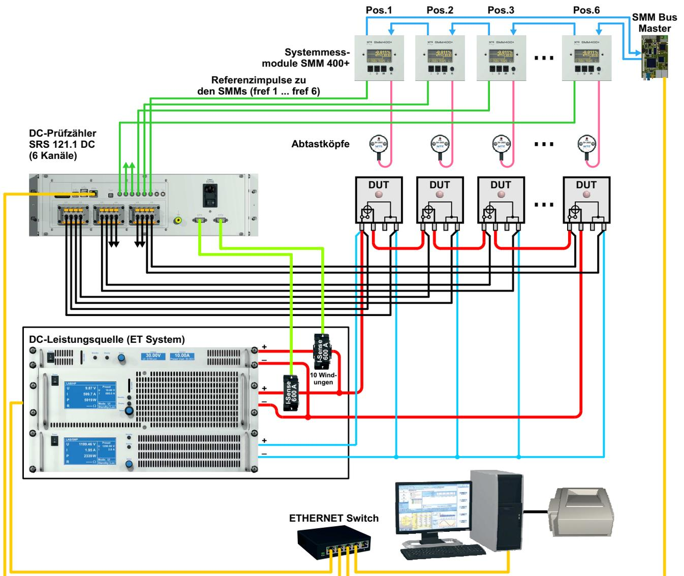
Das DC-Zähler-Kalibriersystem ist für die Prüfung von einphasigen DC-Elektrizitätszählern mit offenen und geschlossenen I-P-Verbindungen konzipiert. Es ist vollelektronisch, verwendet nur elektronische Halbleiterkomponenten und wird von einem PC über die integrierten Ethernet Schnittstelle gesteuert.
