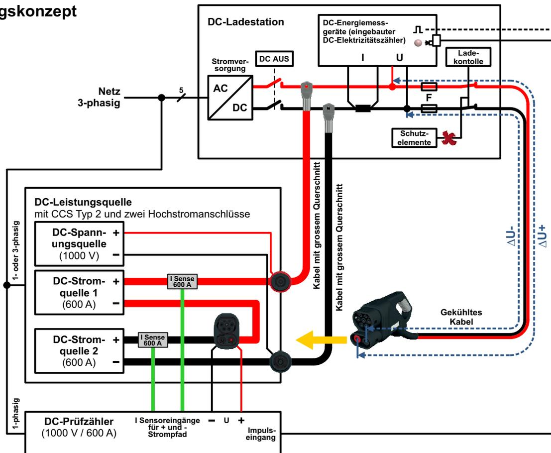
Eine DC-Spannungsquelle (bis zu 1000 V) und zwei DC-Stromquellen (bis zu 600 A) werden verwendet, um eine variable DC-Last (bis zu 600 kW) zu simulieren und die Verluste zwischen des internen Messgerätes und dem Ende des Ladekabels (Spannungsabfall  $\Delta U$ ) zu simulieren.
