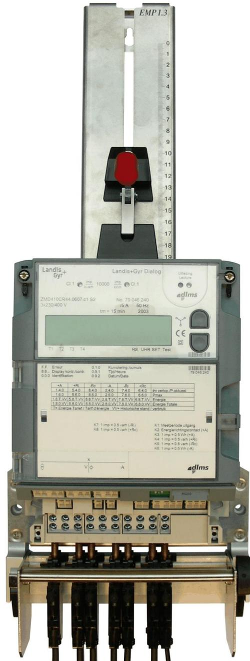
Die Schnellspannvorrichtung EMP 1.3 wird überall dort eingesetzt, wo zum Zwecke der Justierung und Beglaubigung Elektrizitätszähler schnell und zeitsparend angeschlossen werden müssen.
