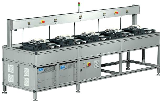
Beispiel eines Prüfsystem zur Kalibrierung von 5 einphasigen DC-Elektrizitätszähler
