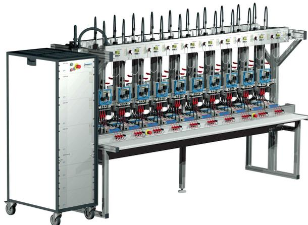
Beispiel eines Prüfsystems mit ICT 2.3 für die Prüfung von 20 dreiphasigen Zählern mit geschlossenen Eichverbindungen
