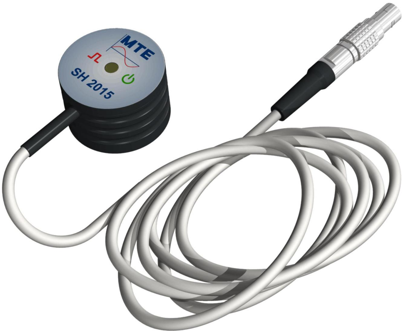
Der fotoelektrische Abtastkopf SH 2015 ist speziell für elektronische Zähler entwickelt worden. Im fotoelektrischen Abtastkopf ist ein ringförmiger Dauermagnet versehen. Dadurch kann der Abtastkopf bei Zählern, welche eine eingebaute Metallscheibe oder Ringmagnet an der Leuchtdiode besitzen, magnetisch platziert werden.
